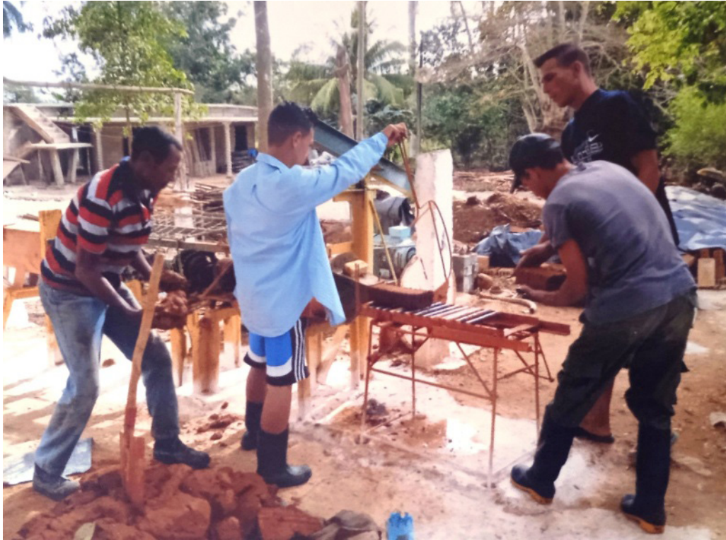
Figura 12. Fábrica artesanal de ladrillos.
